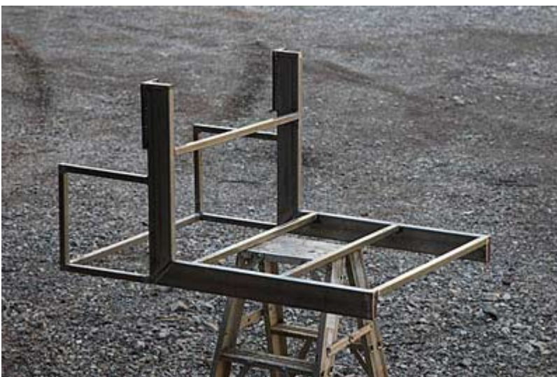
Le générateur et le compresseur resteront à l'extérieur du châssis, à droite. Le cadre à gauche se glissera sous le châssis et pourra être utilisé pour le stockage général, sans doute huile, graisse, pistolet à graisse, etc.
