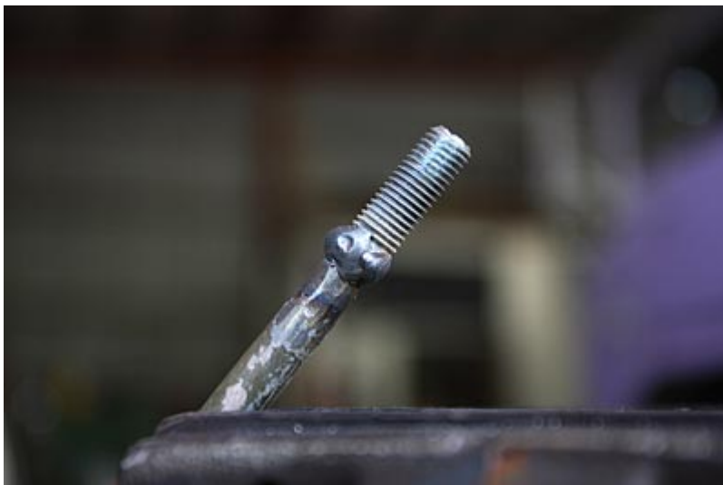
La soudure terminée avant finition.
