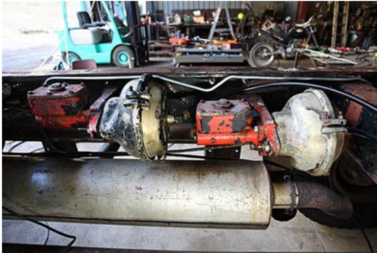
Les deux servofreins. Les ACCOs en ont deux ce qui devrait permettre d'arrêter le camion si l'un est en panne.
