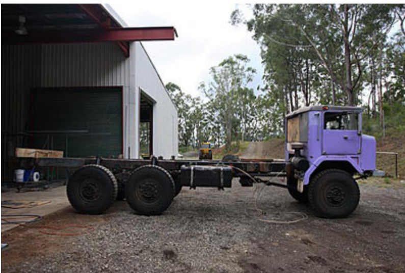
Tout est en place été nous voyons la version raccourcie du camion. L'arrière du châssis doit encore être coupé d'aplomb avec les pneus. Un travail que je ferai dans quelques jours.
