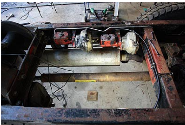
Déplacer les servofreins dégage un espace important sur le coté gauche du châssis (haut de la photo) dans lequel je mettrai le réservoir d'eaux grises.
