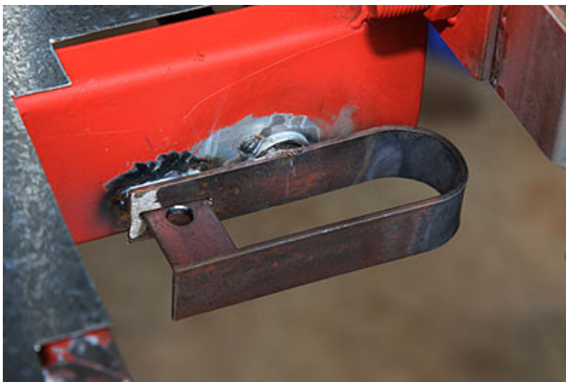
La poignée de la barre coulissante. Tirez dessus pour débloquer les coffres.
