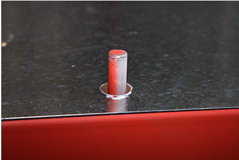
Un boulon de verrouillage émergeant du plancher d'un bac de rangement.
